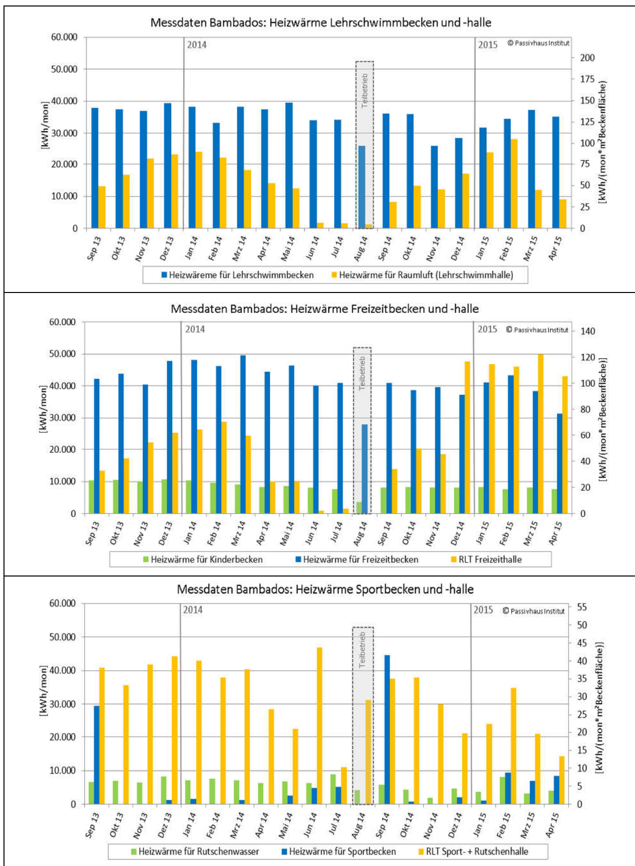
Abbildung 16: Vergleich des Heizwärmeverbrauchs für Becken und Raumlufte aufgeteilt auf die drei Hallenbereiche. (Die linke y-Achse mit den Absolutwerten ist in allen drei Diagrammen gleich skaliert, auf der rechten y-Achse ist jeweils der Verbrauch pro m² Beckenfläche dargestellt.)
