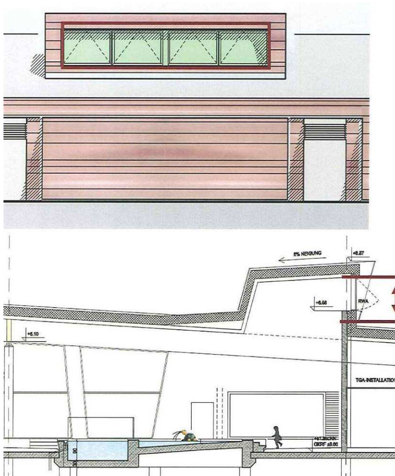
Abbildung 31: Verbesserungsvorschlag zur Optimierung der Tageslichtausbeute des östlichen Neubaus durch höhere Oberlichter
